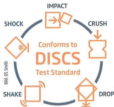
Das von DS Smith entwickelte Prüfverfahren DISCS besteht aus fünf Einzeltests. Jeder davon simuliert einen Teil der Produktreise im E-Commerce. Auf diese Weise lassen sich alle realen Belastungen während des Online-Lieferzyklus nachvollziehen.
