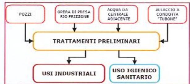
Al fine di ottimizzare l'impiego delle risorse idriche, l'intero ciclo delle acque è strutturato in modo da favorire il massimo riutilizzo delle acque di processo attraverso un'articolata rete di recupero e redistribuzione delle acque.
